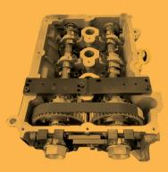
da Tracker), esses motores fazem uso de uma correia dentada banhada em óleo (assim como outros motores tricilíndricos da Ford e da PSA (Peugeot / Citroën). O procedimento para substituição dessa correia dentada é relativamente complexo e exige 3 ferramentas específicas: Raven 131016, 131017 e 131018, disponíveis em avulso ou reunidas no conjunto 131502, que possui um melhor custo-benefício, além de uma maleta plástica.
