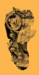
manivelas à árvore de comando de escapamento (que é conectada à árvore de comando de admissão através de uma corrente). O procedimento para posicionar esse motor em sincronismo é simples; apesar disso, demanda as 5 ferramentas que compõem o conjunto Raven 161017 (que inclusive é fornecido em um estojo plástico).
