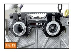
**36** - Afrouxe o parafuso do tensionador da correia dentada, liberando a tensão do mesmo. Em seguida, utilizando uma chave Allen, gire o tensionador no sentido anti-horário, até que o orifício do indicador móvel de tensão fique alinhado ao centro da lacuna na placa dianteira do tensionador (Fig. 14a), e então insira um dos pinos do conjunto 101700 no orifício do indicador de tensão (Fig. 14b), travando o tensionador.
